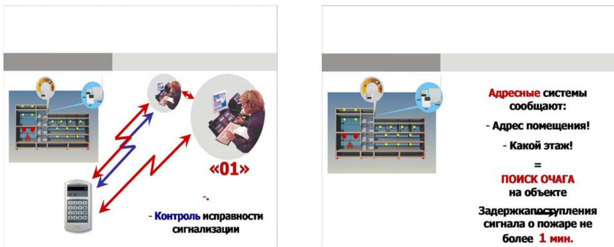
Рис. 3. Алгоритм функционирования адресной радиоканальной системы мониторинга безопасности объектов
